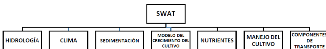
Figura 2-4: Componentes del modelo SWAT.
